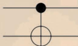
Führt ein NOT auf dem Zielqubit aus, wenn sich das Steuerqubit im Zustand  $|1\rangle$  befindet. Zusammen mit dem H-Gatter kann mit dem CNOT-Gatter eine Verschränkung realisiert werden.
